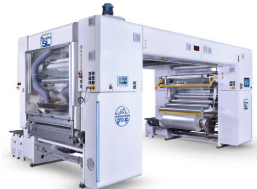
Mit einer neuen Kaschiermaschine bietet ACW-Film seinen Kunden nun die Vorteile einer lösungsmittelfreien Kaschierung an. ©ACW-Film
